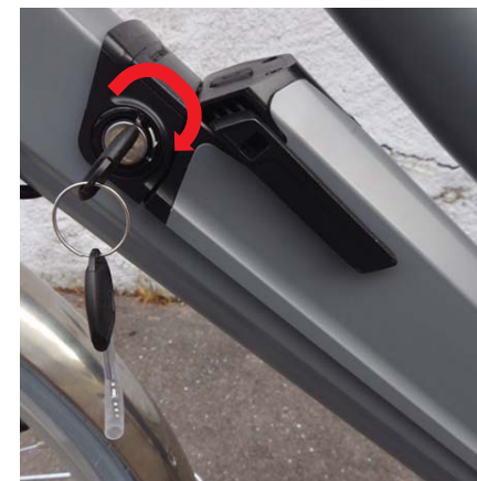
Pour retirer la batterie, tournez la clé vers la droite
